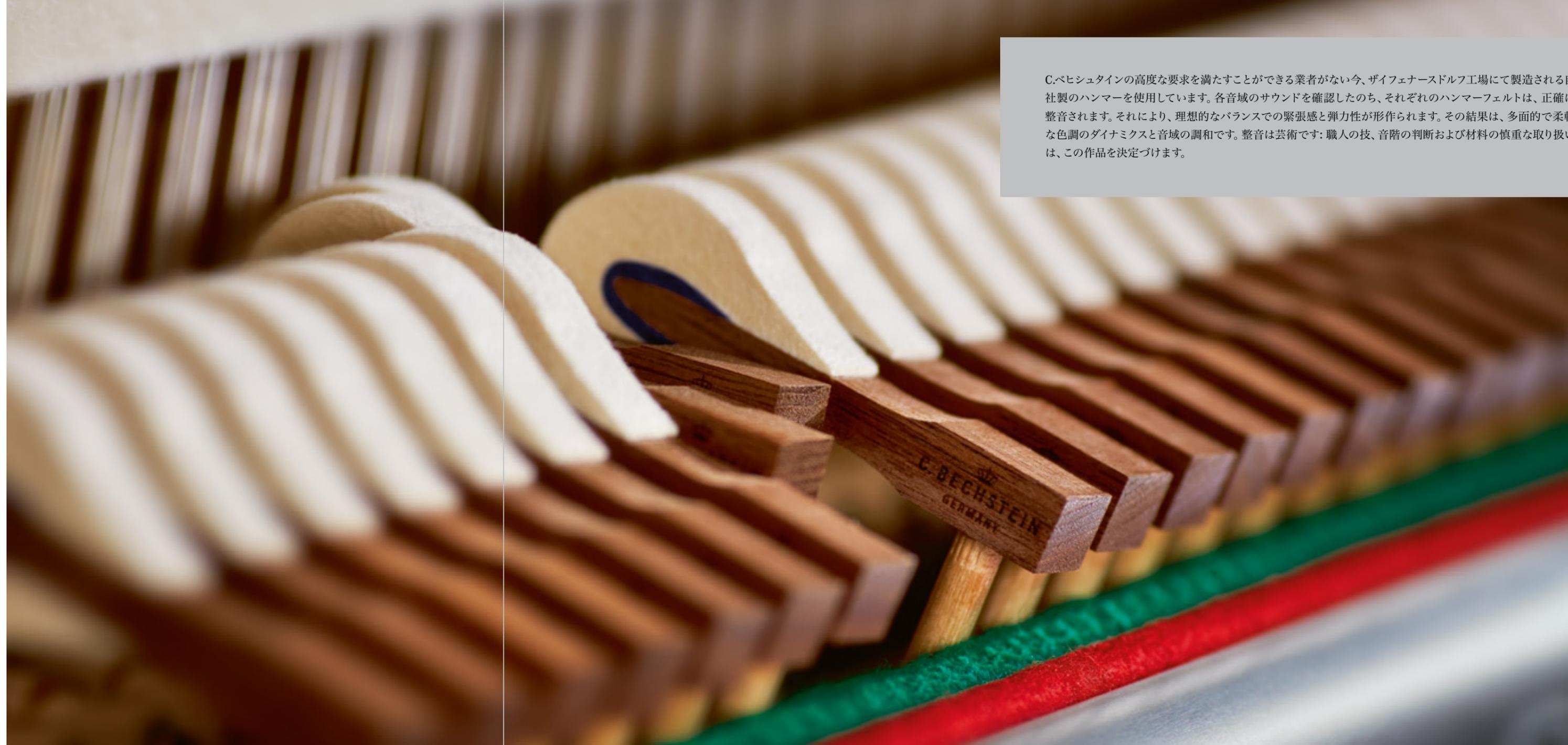
C.ベヒシュタインの高度な要求を満たすことができる業者がない今、ザイフェナーズドルフ工場にて製造される自社製のハンマーを使用しています。各音域のサウンドを確認したのち、それぞれのハンマーフェルトは、正確に整音されます。それにより、理想的なバランスでの緊張感と弾力性が形作られます。その結果は、多面的で柔軟な色調のダイナミクスと音域の調和です。整音は芸術です：職人の技、音階の判断および材料の慎重な取り扱い、この作品を決定づけます。
